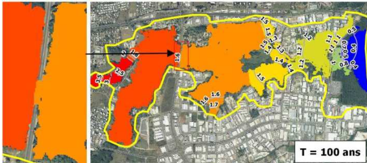
Niveau d'eau en cas de forte pluie
